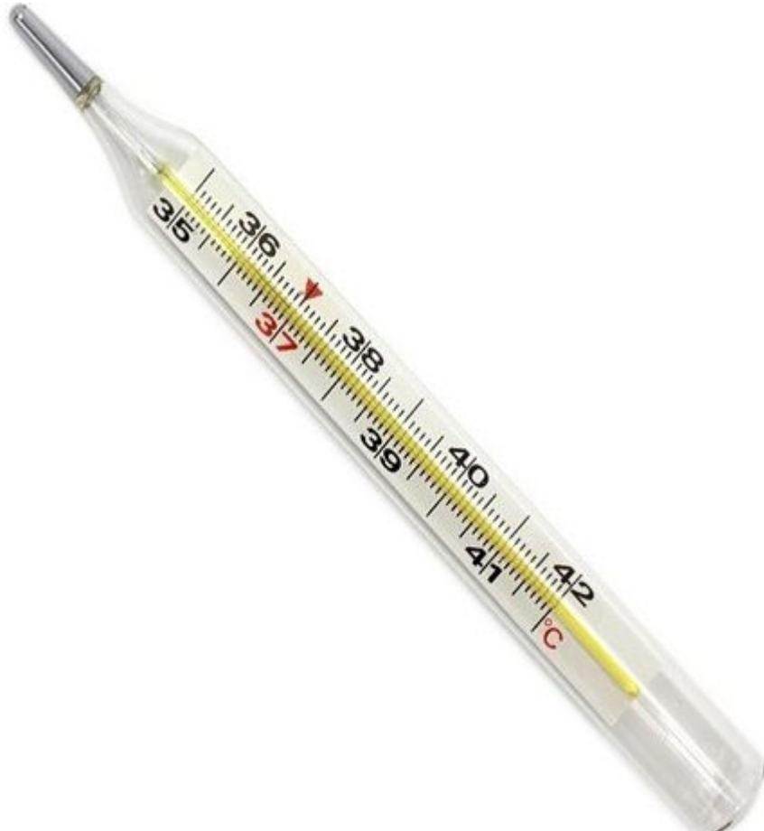
Se mide con un instrumento llamado **TERMÓMETRO**, el que puede estar graduado en distintas **ESCALAS DE MEDIDA** como:
