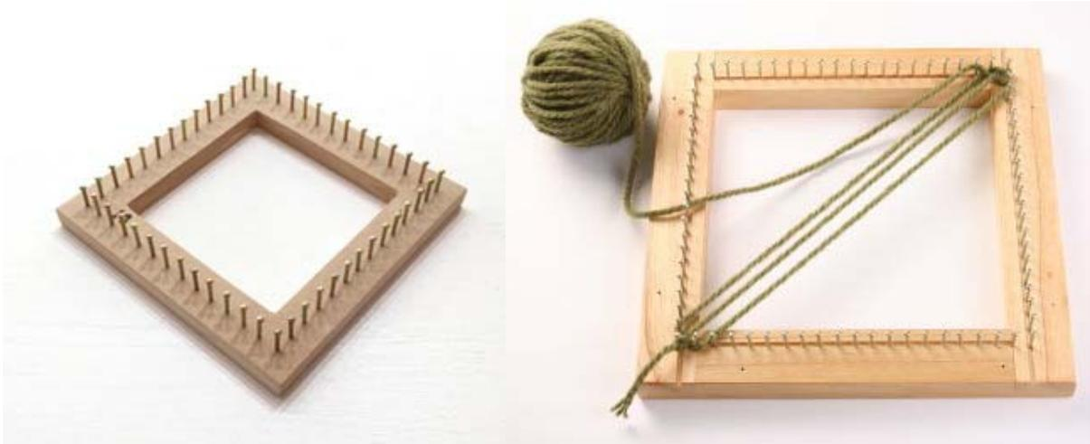
Se denomina telar al dispositivo de madera que se utiliza para tejer. Los telares suelen fabricarse con metal o con madera. A nivel general, puede decirse que disponen de urdimbres (hilos dispuestos de forma paralela), que se tensan con pesas. Existen muchas formas.
