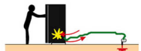
TOMA CON PUESTA A TIERRA
